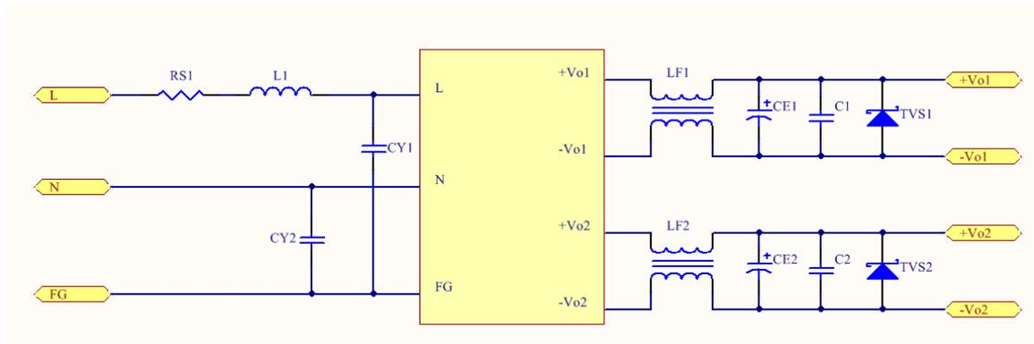
图 2：EMC 更高要求推荐电路
